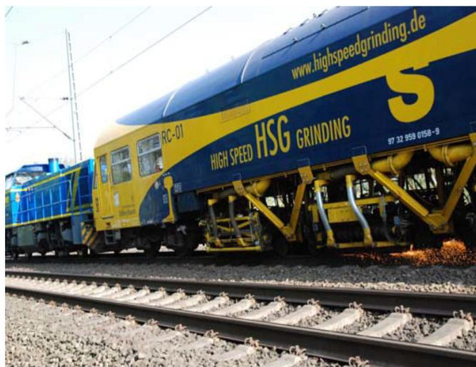
Bild 30: Schleifzug HSG
