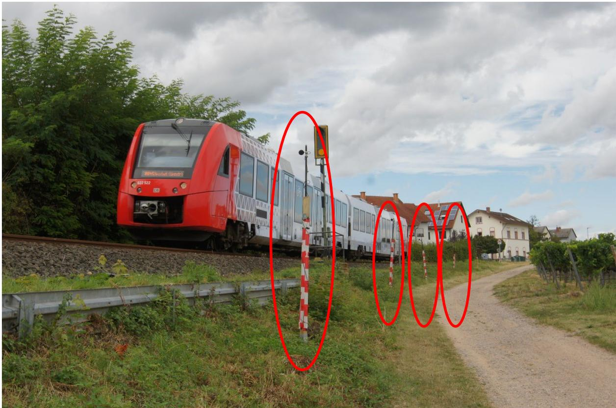
Abbildung 30: Messaufbau am Testabschnitt SSD gegen Kurvenquietschen an der Teststrecke 3436 bei Wachenheim (Quelle: DB AG).
