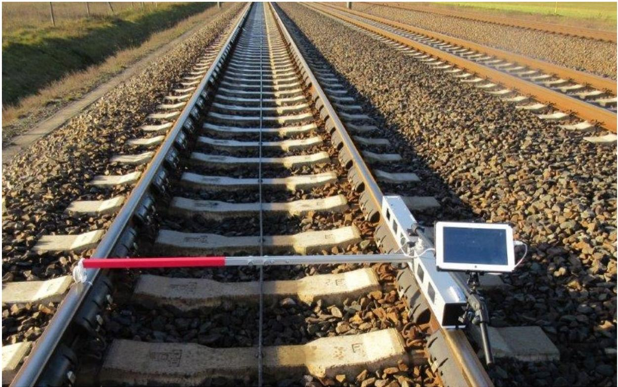
Abbildung 8: Messung der Schienenrauheit mit einem stationären Messsystem (Quelle: DB AG).
