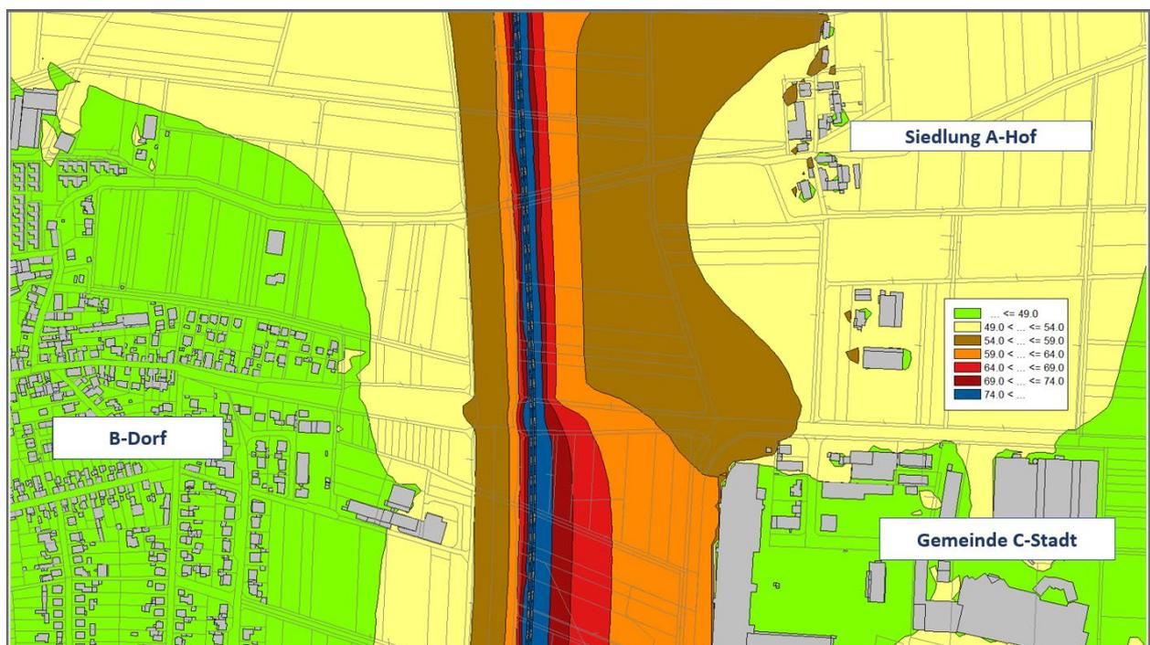
Abbildung 14: Schallschutzmaßnahmen in Lärmvorsorge und Lärmsanierung werden auf Basis einer Prognose mittels Schall 03 für die betroffenen Immissionsorte festgelegt (Quelle: DB AG).
