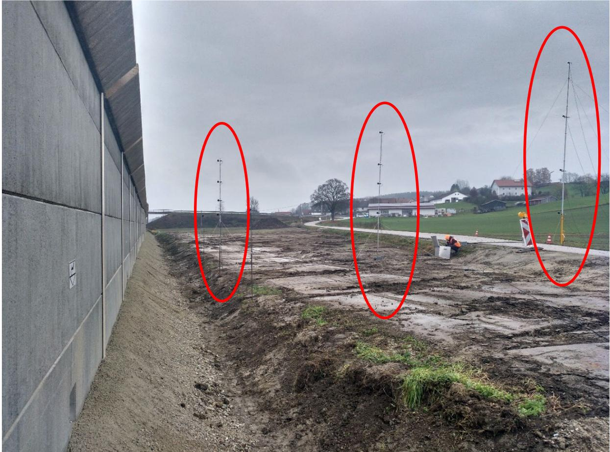
Abbildung 6: Messaufbau an der Schallschutzwand mit Aufsatzelement an der Teststrecke 5500 bei Langenbach (Quelle: DB AG).
