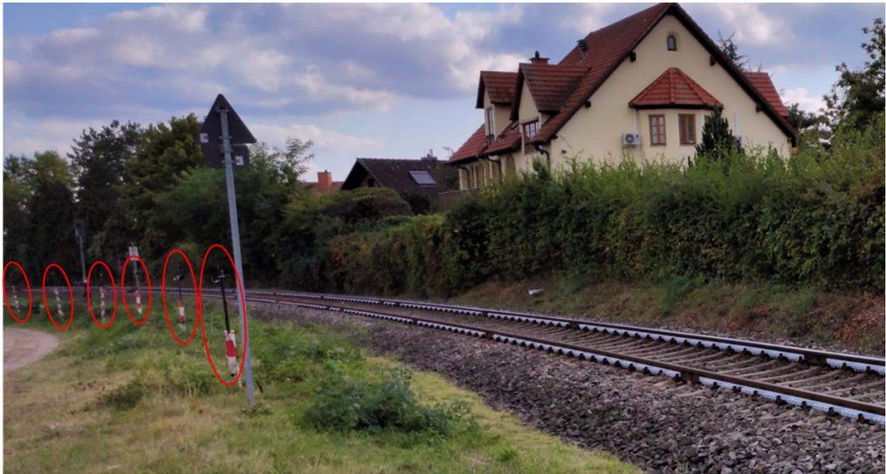
Abbildung 61: Beispiel einer Mikrofonkette (innerhalb der roten Ovale) während der Messung an der Strecke 3436 bei Wachenheim.
