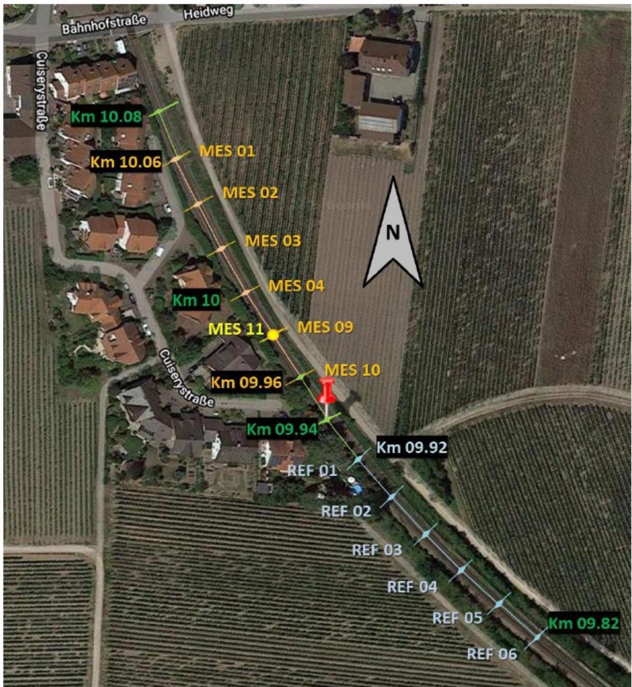
Abbildung 77: Verteilung der Messpositionen entlang der Strecke 3436 im südlichen Einfahrbereich zum Bahnhof Wachenheim, im Testabschnitt (Luftschall: MES 01 bis MES 10, Körperschall: MES 11) und im angrenzenden Referenzabschnitt (Luftschall: REF 01 bis REF 06).
