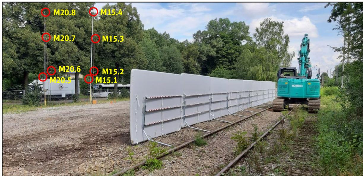
Abbildung 101: Feste Absperrung mit 2 m hohen Schallschutzelementen. Die roten Kreise markieren Mikrofonpositionen im Abstand von 15 m bzw. 20 m von Gleismitte.
