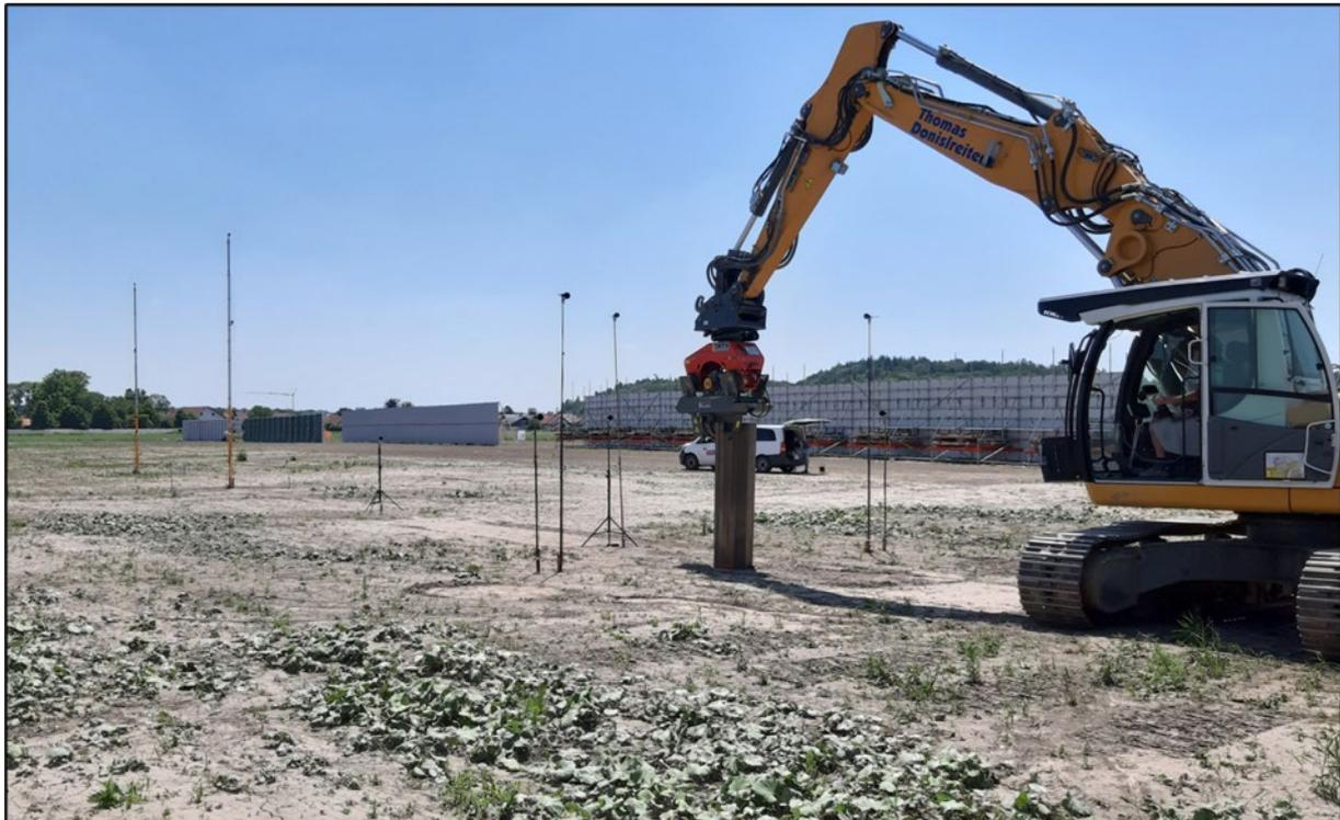
Abbildung 87: Testfeld bei Tüßling. Mobile Schallschutzwände unterschiedlicher Bauform mit einer Höhe von ca. 4 m wurden jeweils auf einer Länge von 50 m aufgebaut (im Hintergrund). Im Vordergrund sichtbar sind die Schallquelle ‚Vibrationsramme‘ und die Mikrofone für eine Messung der Schalleistung der Quelle sowie weiter hinten die Mikrofone für Messungen in der Referenzebene.
