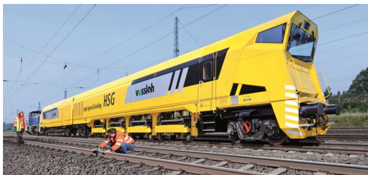
Abbildung 5.1: Schienenschleifzug für akustisches Schleifen (Quelle: Vossloh Rail Services)
